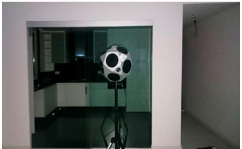
Prueba acústica "in situ"
